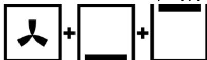
Top and bottom heat+ fan Ober- und Unterhitze + Umluft Верхний и нижний нагрев + обдув 165 °C (50 – 250 °C)
