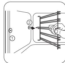
**2** Вытяните заднюю часть направляющей для противня из боковой стенки и снимите ее.
