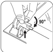
6 Поверните два фиксатора на 90°, затем извлеките их из своих гнезд.
