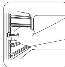
**1** Потяните переднюю часть направляющей для противня в сторону, противоположную боковой стенке.
