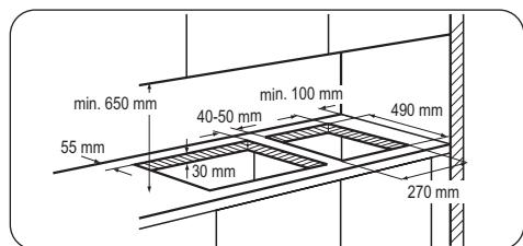
В случае, если несколько 30 см варочных поверхностей необходимо установить одну рядом с другой в одном вырезе столешницы, можно обратиться в сервисный центр за набором для монтажа, который включает в себя боковую опорную скобу и дополнительные уплотнители. Необходимые инструкции находятся внутри упаковки данного набора.
