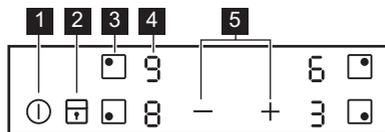
Управление прибором осуществляется с помощью сенсорных полей. Работа функций подтверждается выводом информации на дисплей, а также визуальной и звуковой индикацией.
