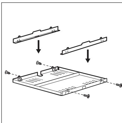
Якщо використовується захисний короб (додаткове приладя), пропір попереду 2 мм для притоку повітря та захисна підлога безпосередньо під варильною поверхнею не потрібні. Захисний короб може бути відсутнім у деяких країнах. Зверніться до місцевого постачальника.
