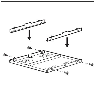
В случае использования защитного экрана (приобретается отдельно) фронтальный 2-мм вентиляционный зазор и защита пола под варочной панелью не являются обязательными. В ряде стран защитный экран может отсутствовать в списке доступных дополнительных принадлежностей. Обратитесь к своему поставщику.
