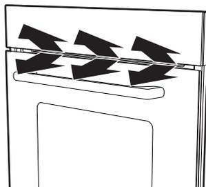
Вентилятор охлаждает духовку и включается во время приготовления. Вентилятором создается нормальный поток воздуха, который выходит над дверцей, и может продолжать поступать кратковременно также после выключения духовки.
