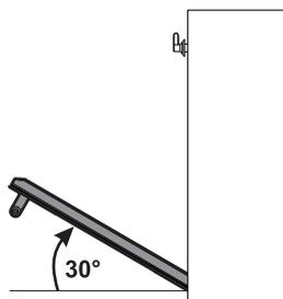
3. Для повторной установки вставить петли в специальные отверстия, имеющиеся в духовке, убедившись в том, что желобки В прислоняются полностью на отверстия. Опустить дверцу вниз и после ее установки вынуть стержни из отверстий петель.
