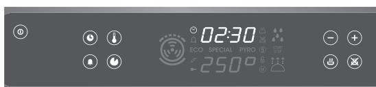
В положении ОЖИЖАНИЕ с визуализацией часов нажать один раз на символ . Для указания о том, что сейчас можно выбрать функцию жарки или чистки, зажигаются кнопки, чувствительные к прикосновениям.
