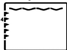
Включен нагреватель гриля, расположенный на верхней стенке духовки. Может использоваться для приготовления блюд на гриле.
