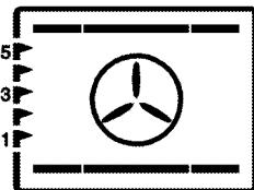
Включены верхний, нижний и кольцевой нагревательные элементы и вентилятор, расположенный на задней стенке. Продукты прогреваются равномерно со всех сторон и быстро готовятся. Готовьте только с одним противнем.
