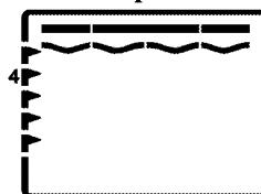
Включен большой нагреватель гриля, расположенный на верхней стенке духовки. Может использоваться для приготовления на гриле большого количества продуктов.
