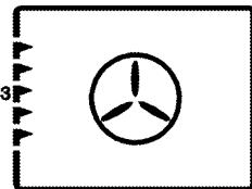
С помощью вентилятора воздух, нагреваемый задним нагревательным элементом, очень быстро и равномерно распределяется по всей духовке. Это дает возможность готовить пищу в духовке на разных уровнях. Кроме того, в большинстве случаев исключает необходимость предварительного прогрева духовки. Подходит для приготовления с несколькими противнями.
