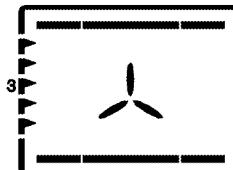
С помощью вентилятора воздух, нагреваемый нижним и верхним нагревательными элементами, очень быстро и равномерно распределяется
