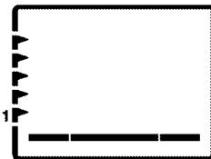
Включен только нижний нагревательный элемент. Отлично подходит для приготовления блюд, которые должны пропекаться снизу, например, пиццы.
