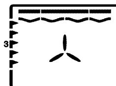
С помощью вентилятора воздух, нагреваемый большим нагревателем гриля, очень быстро и равномерно распределяется по всей духовке. Это дает возможность готовить на гриле большое количество мяса.
