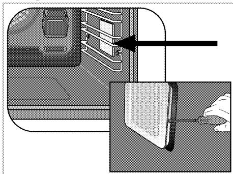
3. Приподнимите стеклянный колпачок с помощью отвертки.
