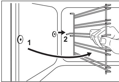
2. Вытяните заднюю часть направляющей для противня из боковой стенки и снимите ее.
