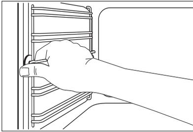
1. Потяните переднюю часть направляющей для противня в сторону, противоположную боковой стенке.
