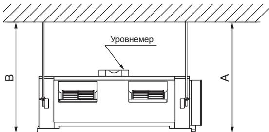
Страна А устройства с дренажным отверстием должна находиться немного ниже, чем противоположная страна В устройства. Разница по высоте между странами А и В должна быть от 0 до 20 мм.
