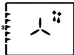
Духовка не нагревается. Работает только вентилятор, расположенный на задней стенке. Замороженные гранулированные продукты медленно размораживаются при комнатной температуре, а приготовленные продукты охлаждаются.
