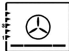
Включены нижний и кольцевой нагревательные элементы, и вентилятор, расположенный на задней стенке. Может использоваться для приготовления пиццы.
