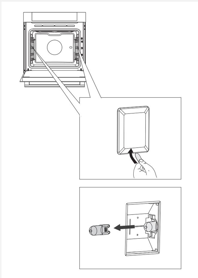
**1** С помощью отвертки снимите крышку.
