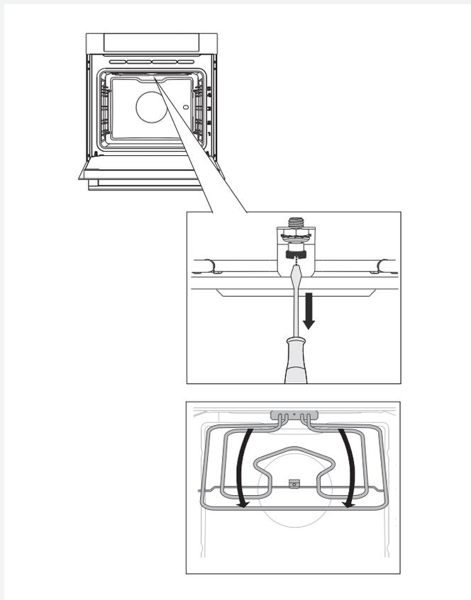
**1** Чтобы освободить верхние нагреватели, открутите винт в передней части потолка духовки.
