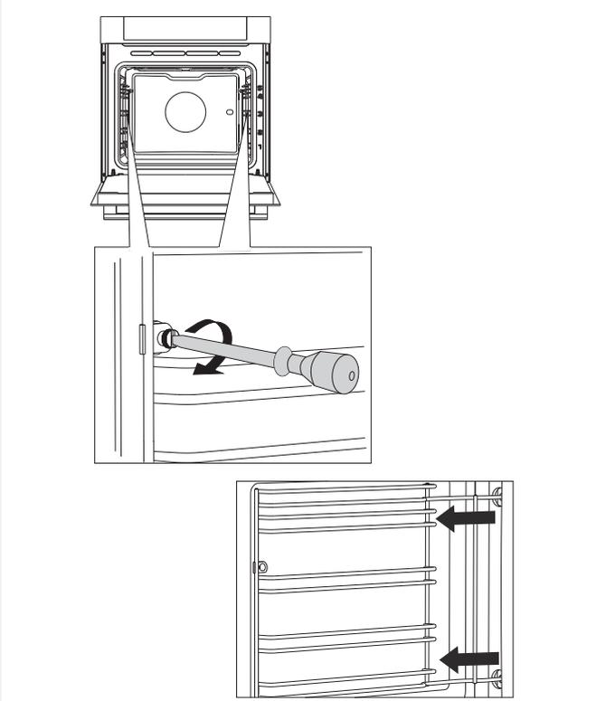
**1** Открутите винт с помощью отвертки.
