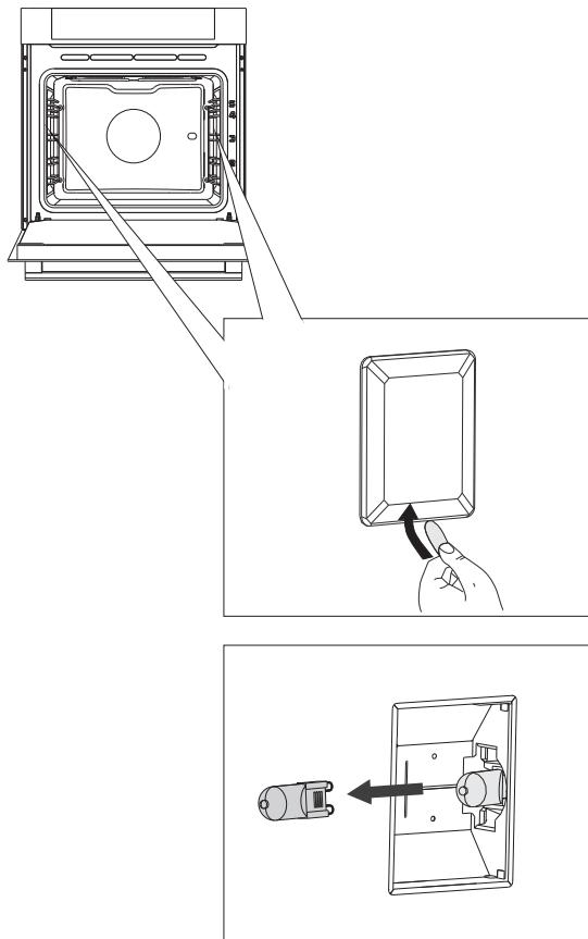
**1** С помощью отвертки снимите крышку.
