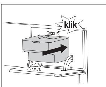
**4** Задвиньте резервуар в отсек до положения срабатывания фиксатора. Закройте крышку отсека, нажав на нее.
