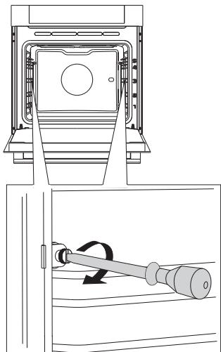
**1** Открутите винт с помощью отвертки.
