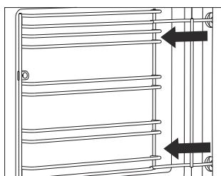
**2** Извлеките направляющие из отверстий в задней стенке.
