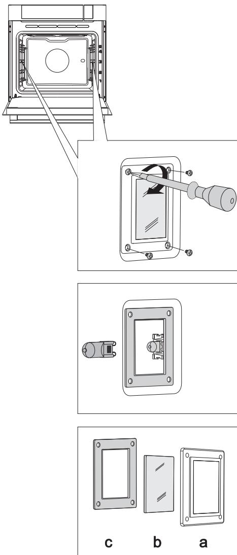
**1** Открутите четыре винта на крышке. Снимите крышку.
