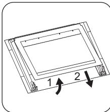
**7** Сначала осторожно поднимите и выньте стеклянную панель.
