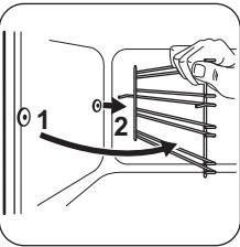
**2** Вытяните заднюю часть направляющей для противня из боковой стены и снимите ее.
