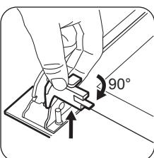
**6** Поверните два фиксатора на 90° и извлеките их из своих гнезд.
