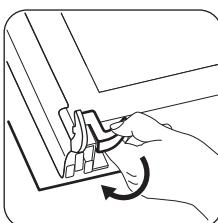
**5** Отожмите стопоры, чтобы снять внутреннюю стеклянную панель.
