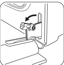
**2** Поднимите и поверните рычажки, расположенные в обеих петлях.
