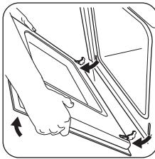
**3** Прикройте дверцу наполовину до первого фиксируемого положения. Затем вытяните дверцу вперед из ее гнезда.
