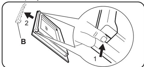
7. Чтобы снять дверную планку, потяните ее вперед.
