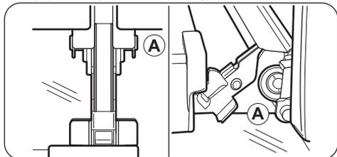
3. Прикройте дверцу до первого фиксируемого положения (приблизительно на угол 70°).
