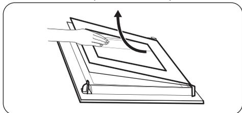
9. Вымойте стеклянную панель водой с мылом. Тщательно вытрите стеклянную панель.
