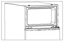
6. Открутите винты на нижней петле, снимите нижнюю петлю, снимите нижнюю дверцу, выкрутите ножку холодильника с левой стороны.
