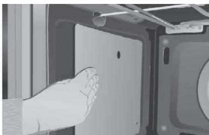
4. Для разборки панели на задней части духовки следует снять винт (D).
