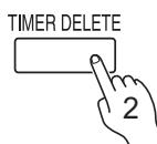
Нажмите кнопку SET BACK (СПЕЦ. ТАЙМЕР), а затем нажмите кнопку TIMER DELETE (УДАЛЕНИЕ ТАЙМЕРА), пока отображается экран подтверждения SET BACK. Даже если повторно нажать на кнопку SET BACK (СПЕЦ. ТАЙМЕР), таймер специальной температуры SET BACK будет отключен.
