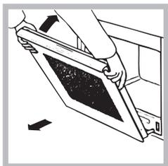
3. возьмитесь за дверцу руками с двух сторон, плавно закройте ее, но не полностью. Затем потяните дверцу на себя, снимая ее со своего гнезда (см. схему). Для установки дверцы на место выполните вышеописанные операции в обратном порядке.
