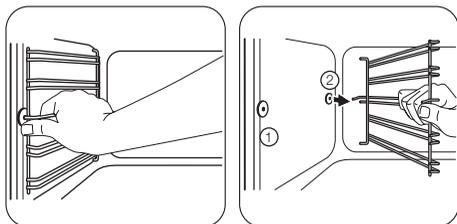
**1** Потяните переднюю часть направляющей для противня в сторону, противоположную боковой стенке.
