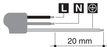
по крайней мере, 20 мм. Применяйте исключительно кабель типа H05V2V2-F или аналогичный, рассчитанный на максимальную температуру 90°C. Замена должна производиться специалистом, который должен выполнять подключение к сети согласно приведенной ниже схеме.
