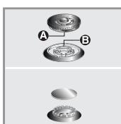
Для корректного функционирования запальных свечей и термопар они должны быть всегда хорошо очищенными. Почкаще проверяйте их и, при необходимости, очищайте влажной тряпкой. Присохшие остатки можно удалить деревянной зубочисткой или иголкой.
