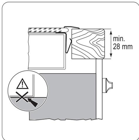
**i** Ja izmantojat aizsargnodalījumu (papildpiederums<sup>3)</sup>), aizsargplāksne tieši zem ierīces nav nepieciešama. Ja uzstādāt ierīci virs cepeškrāsns, aizsargkārbu nedrīkst izmantot.
