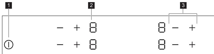
Utilizzare i tasti sensore per mettere in funzione l'apparecchiatura. I display e gli indicatori indicano le funzioni attive.
