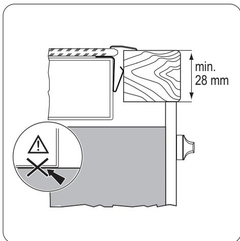
**i** В случае использования защитного короба (дополнительная принадлежность<sup>4)</sup>), установка защитного пола непосредственно под устройством не является обязательной.
