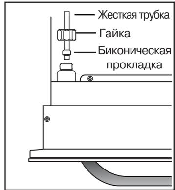
2. Завершите подключение, затянув гайки ключом на 24 мм, обращая внимание на то, чтобы не подвергать механическим напряжениям газовые трубки (Рис. 3);
