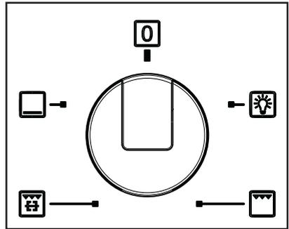
Поворотом ручки выбора режима на соответствующие символы Вы можете задать нужный режим. Одновременно загорится лампочка внутреннего освещения духового шкафа.
