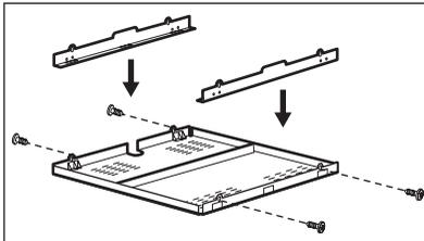
В случае использования защитного короба (дополнительная принадлежность<sup>1)</sup>), установка защитного пола непосредственно под устройством не является обязательной. В случае установки прибора над духовым шкафом использование защитного экрана невозможно.
